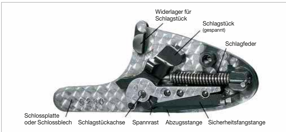
Aufbau eines Seitenschlusses
