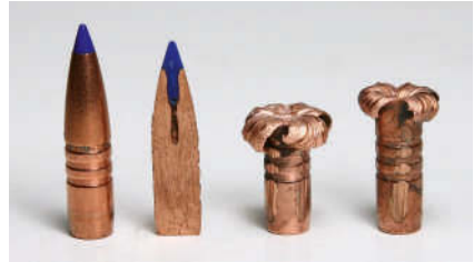
Barnes TTSX (bleifrei), Deformationsgeschoss
