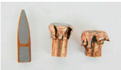
Nosler Partition Zweikammergeschoss mit geborgenen Geschossen
