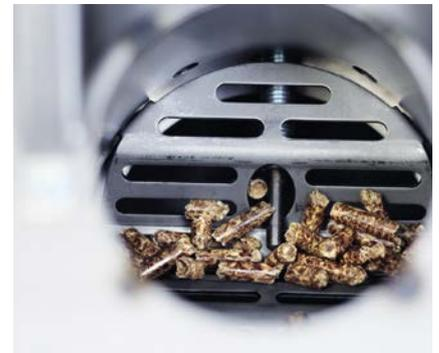
**6.** Die mittig angeordnete Glühkerze zündet mittels Initialzündung die ersten Pellets. Der Lüfter schaltet sich zu und sorgt durch Luftzufuhr für die zusätzliche Befeuung bis zur eingestellten Zieltemperatur.
