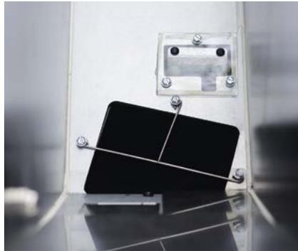
**2.** Den Trichter der Pelletkammer öffnen. Der Fingerschutz sorgt für den nötigen Schutz, damit man beim Ein- und Nachfüllen der Pellets nicht in den Bereich der Förderschnecke gelangt. Der darüber befindliche Sensor überwacht die Füllmenge und meldet, sobald nicht mehr ausreichend Pellets zur Verfügung stehen.
